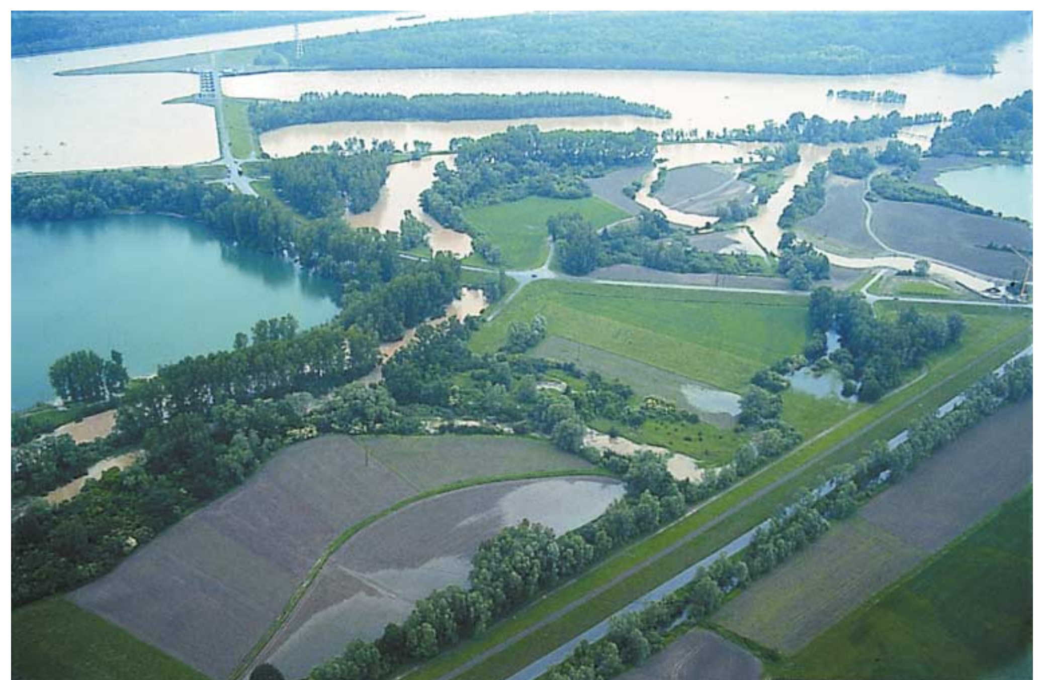
Poldery Altenheim o łącznej powierzchni 520 ha są w stanie zmagazynować 18 mln m 3 wody. Dotychczas, ich współdziałanie ze stopniem Kehl/Strassburg zapobiegło w 1999 roku zalaniu miasta Speyer. Fot. Gewässerdirektion Südlicher Oberrhein/Hochrhein w: The Integrated Rhine Programm. Flood control and restoration of former flood plains on the Upper Rhine. Gewässerdirektion Südlicher Oberrhein/Hochrhein, 1997
