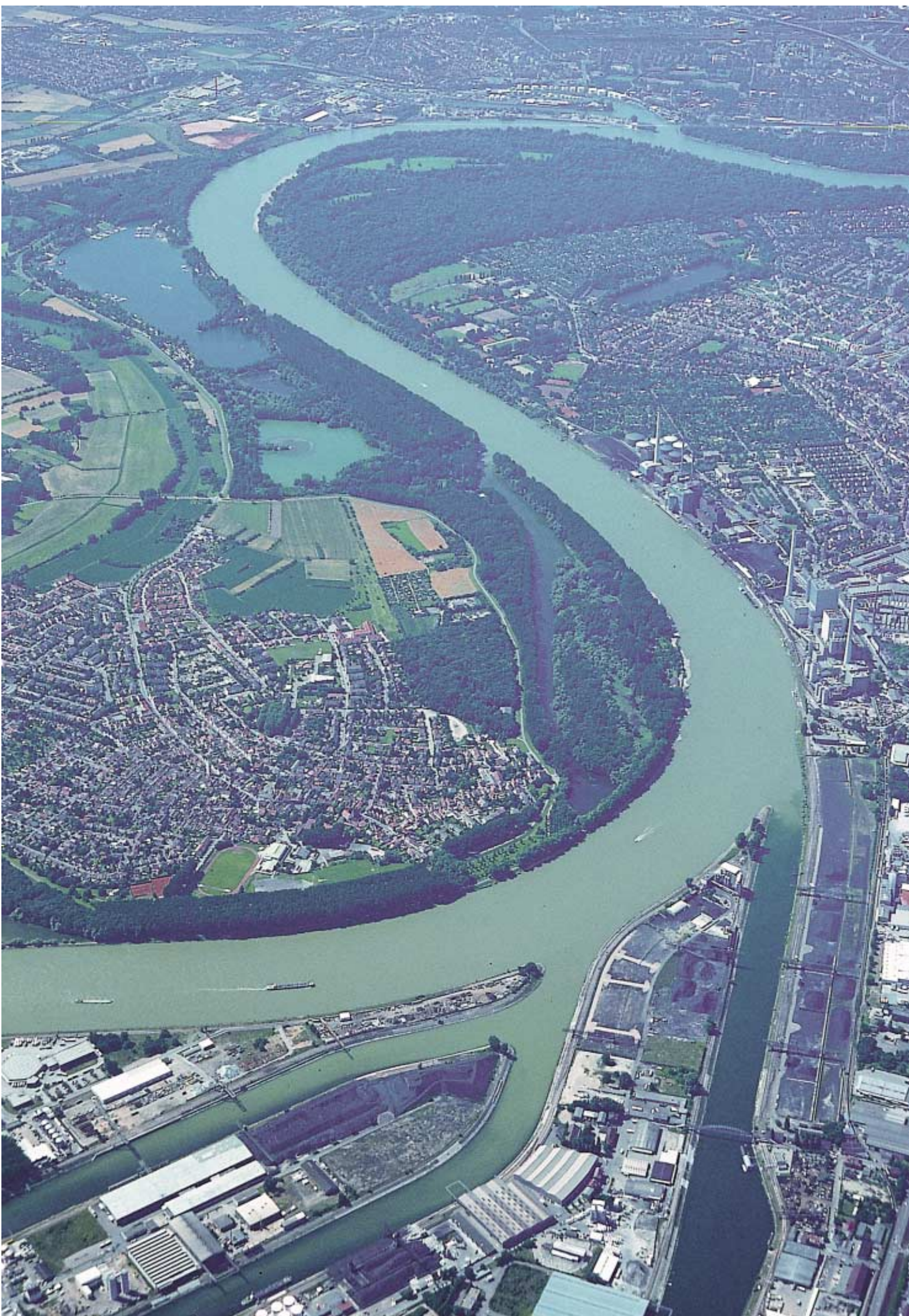
Regulacja Renu zwiększyła ryzyko powodziowe. Zabudowa hydrotechniczna spowodowała podniesienie stanów wody i zmniejszenie czasu przepływu fali powodziowej. Fot. Gewässerdirektion Südlicher Oberrhein/Hochrhein w: The Integrated Rhine Programm. Flood control and restoration of former flood plains on the Upper Rhine. Gewässerdirektion Südlicher Oberrhein/Hochrhein, 1997
